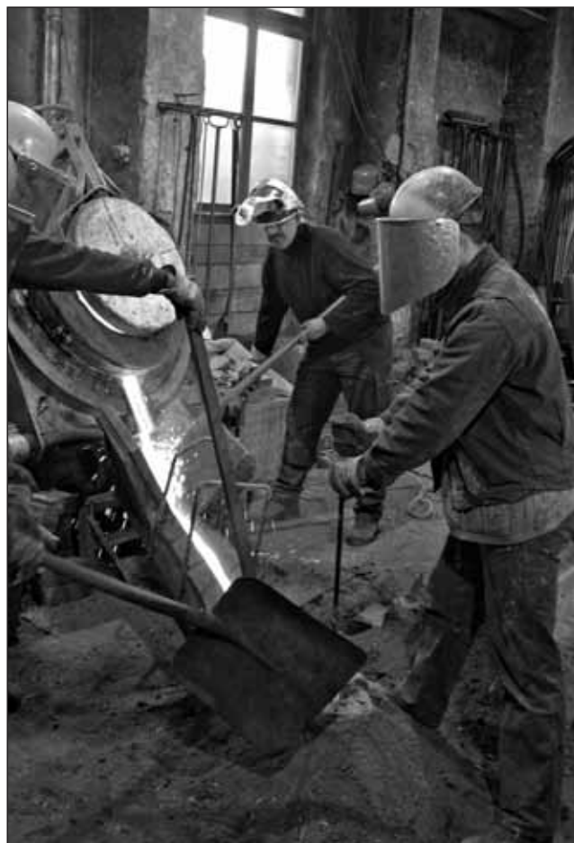
Obr. 12 Lítí zvonu ve zvonařské firmě Perner v Pasově. Velmi dobře je patrné odstříkování drobných kapiček slítiny.
