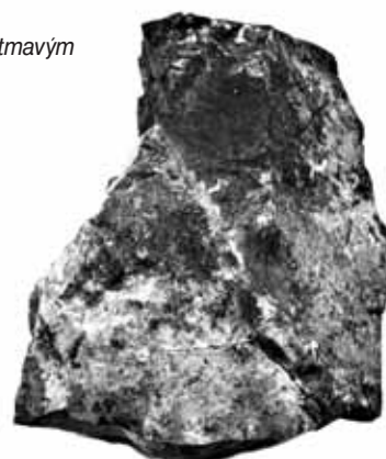
Obr. 6 Zeskovatělý povrch jednoho z křemenců použitých v konstrukci pece.
