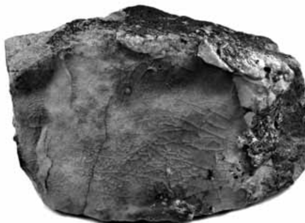
Obr. 6 Zeskovatělý povrch jednoho z křemenců použitých v konstrukci pece.
